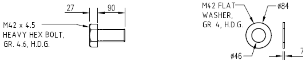
Figura 16. Detalle de los pernos utilizados para fijar el panel al cono de la defensa marina tipo 1. Fuente: Planos de las defensas del muelle de Caldera-Puntarenas, elaborado por Maritime International.
