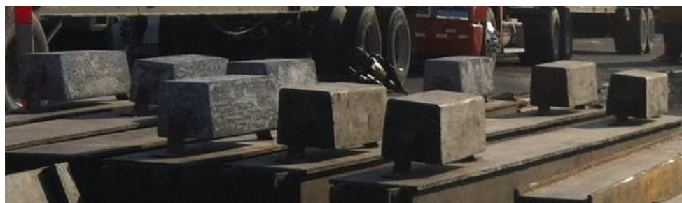
Figura 7. Ánodos de sacrificio para tablestaca. Fuente: Elaboración propia.
